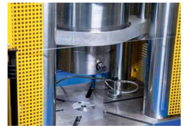
**Rundstößel mit Spannbohrung und Spannschraube**
