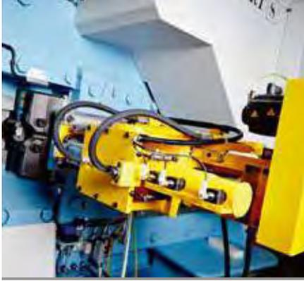
Der seitlich montierte Längenanschlag bietet bestmöglichen Zugang zum Messerbereich.
