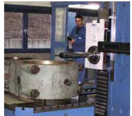
Bohrwerksbearbeitung von Maschinenteilen bis 20 t x 4000 + y 2500 x + z 150 mm.
