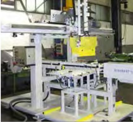
Die Stapelvorrichtung STV M-800 ermöglicht das platzsparende Stapeln oder Entstapeln von Werkstücken. Our stacking device STV M-800 allows a space-saving stacking or de-stacking of your work-pieces.
