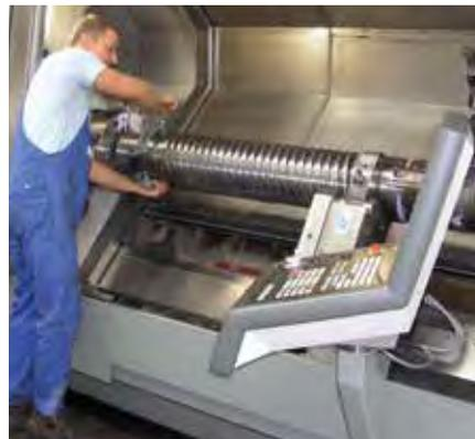
4-gängige Spindel für eine Presse aus dem Vollen gefertigt.
