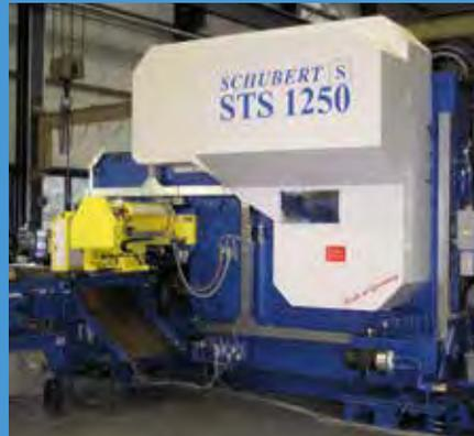
Die von SCHUBERT entwickelte 12500 kN Stabstahlschere ist die größte und stärkste Maschine der STS-Baureihe mit einem Scherdurchmesser von 180 mm im Kaltschnitt.
