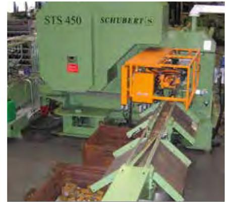
Unsere universellen Abtransportbänder ermöglichen die gesteuerte Befüllung mehrerer Kästen.
