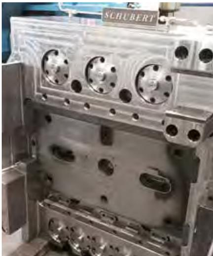
Automatischer Werkzeughalter für eine 31500 kN Schmiedepresse mit einem Gesamtgewicht von 16000 Kg. Dieser wurde komplett bei SCHUBERT konstruiert und gefertigt. Automatic tool holder for a 31.500 kN forging press with a gross weight of 16.000 kN which has been developed and manufactured by SCHUBERT.
