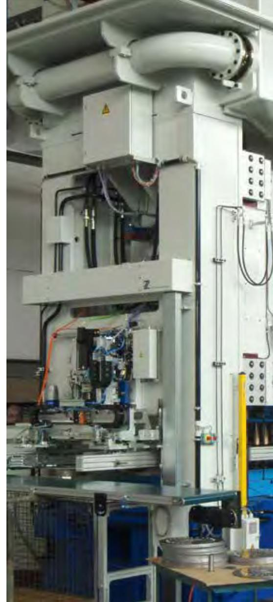
Eine 14.000 kN EXNER Hydraulikpresse nach der Generalüberholung und mit angebauter Transferautomation.
