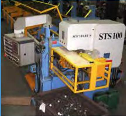
Eine kleine leistungsstarke Schere bis 52 mm Durchmesser im Schneidbereich.
