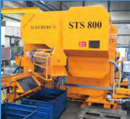
Eine Maschine der Oberklasse, mit einer Schneidleistung bis zu einem Durchmesser von 140 mm.
