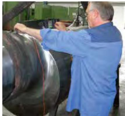
Die Qualitätskontrolle erfolgt durch geschultes Personal, z.B. Ultraschallprüfung einer Exzenterwelle.
