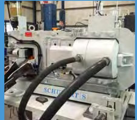
Bei SCHUBERT wurde eine neue hydraulische Stahlschere in einfacher Bauweise entwickelt.
