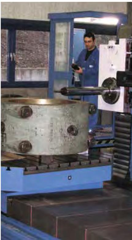
Bearbeitung der Einzelteile auf unseren modernen CNC-Maschinen. (Abb. Bearbeitung eines Presenstößels)
