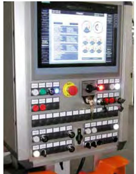
Übersichtliches Bedienfeld mit Handtasten und der neuen Siemens TP1500 Bedienoberfläche.
