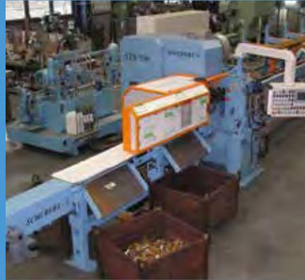
Hochleistungsschere, wird insbesondere in der Pleuel- und Kettenfertigung eingesetzt.
