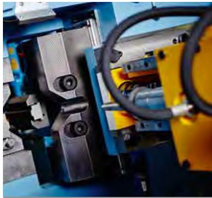
Der Scherenschlitten in neuer Ausführung mit umlaufender Abdichtung und breiten großflächigen Führungen.
